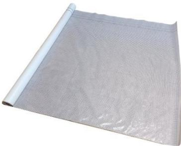
STÖ DB TOP ist eine hochreißfeste, geprüfte transluzente Dampfbremse, bestehend aus einem gitterverstärkten 2-lagigen Verbund aus HDPE und PE-Drehergewebe.
