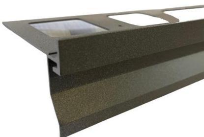
STÖ BALKONRANDPROFIL wird verwendet, um eine optisch sehr ansprechenden Abschlusskante des Steinteppichs zu schaffen. Durch das speziell gebogene und nach unten entwässernde Profil, kann abfließendes Wasser entweichen, ohne das es auf den seitlichen Rand des Balkons abrinnt. Dadurch werden schlieren vermieden. Höhe 10 mm, Länge 2,7 m, Farbe Anthrazit.
