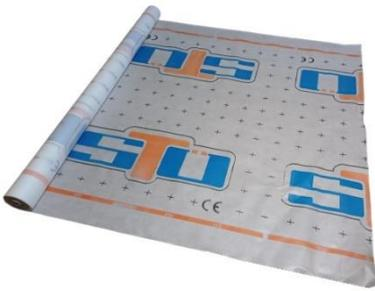
STÖ DB UNI ist eine reißfeste, geprüfte transluzente Dampfbremse und Luftdichtung, bestehend aus einem 2-lagigen Verbund aus PP-Vlies und PP-Film. Dadurch ist die Dampfbremse 100% recyclebar.
