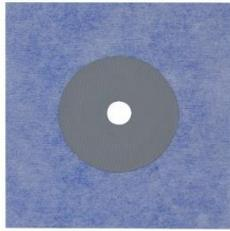
STÖ WANDMANSCHETTE ist eine einseitig vliesbeschichtete, elastische Dichtmanschette mit flexibler Dehnzone aus NBR- Kautschuk und Polyethylenvliesverbund. Zum Abdichten von Rohrdurchführungen in Kombination mit dem STÖ DUSCHDICHT System.
