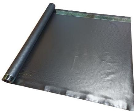
STÖ TOP 280 MONO DSK ND ist eine erhöht regensichere, hoch diffusionsoffene, 2 lagige Schalungsbahn mit zwei wechselseitig angebrachten Klebestreifen für regensichere Unterdächer der neuesten Generation. STÖ TOP 280 MONO DSK ND wurde speziell für den Einsatz unter Photovoltaikanlagen in Verbindung mit extrem hohen Temperaturen entwickelt und ist nageldicht geprüft.
