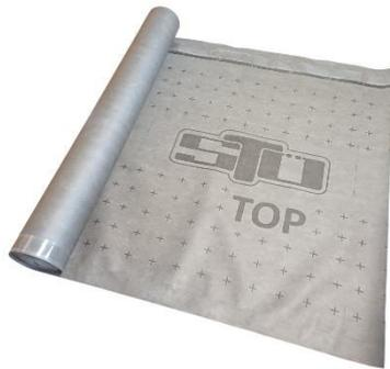
STÖ TOP 175 DSK ist eine hochdiffusionsoffene, schlagregendichte, **mit 2 Selbstklebestreifen** ausgestattete 3-lagige Unterdeckbahn für den Steildachbereich und für Wand-konstruktionen als Wind- u. Feuchtigkeitsschutz. Geeignet für Sanierung und Neubau.
