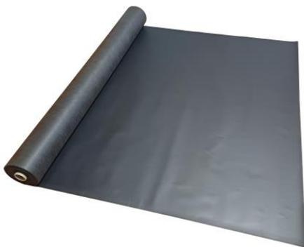
STÖ UV PROTECT FASSADENBAHN ist eine hoch diffusionsoffene, 2-lagige, UV-beständige Fassadenbahn für geschlossene, teiloffene und vollflächig offene Fassaden als Winddichtung im Wandbereich. Der Fugenanteil kann frei gewählt werden. Die hochwertige Acrylatbeschichtung auf robustem Polyestervlies verleiht der Bahn einen hohen Schutz gegenüber UV-Einwirkungen und Schlagregen.
